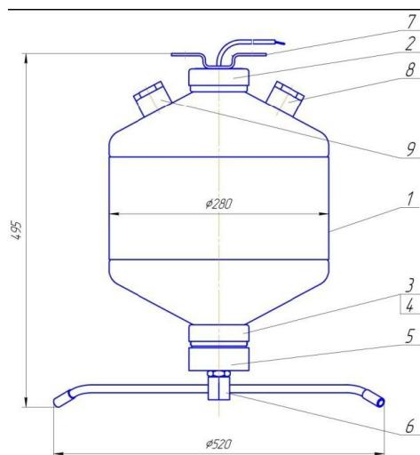
3.2. Срабатывание МУПТВ происходит от электрического импульса источника электропитания, подаваемого на выводы электроактиватора. В ГГЭ (2) начинается интенсивное газовыделение, сопровождающееся нарастанием давления внутри корпуса МУПТВ (1), что приводит к вскрытию мембранны (4) и
