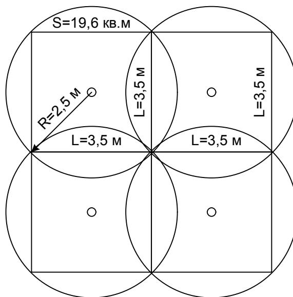
5.3. Допускается производить размещение модулей в шахматном и произвольном порядке при соблюдении перекрывания зон орошения.
