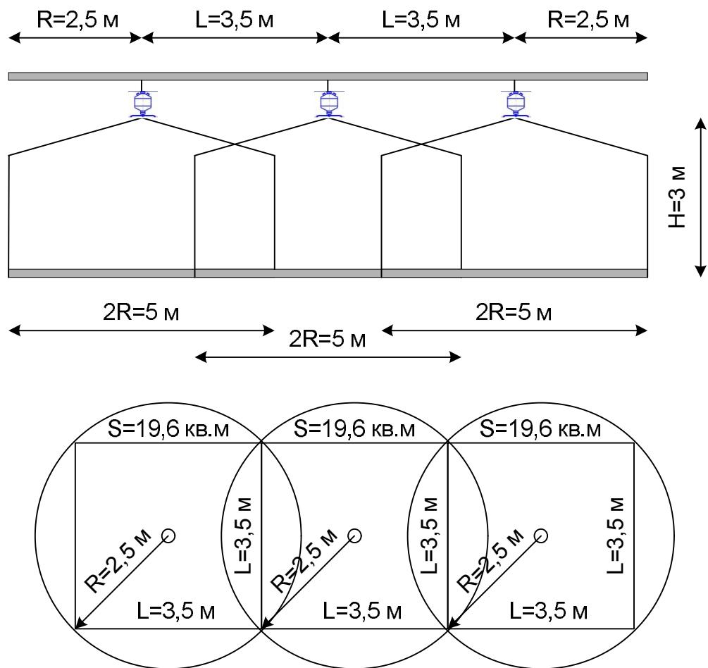
5.2. Взаимную установку модулей рекомендуется выполнять в квадратном порядке. При квадратном расположении модулей достигается максимальная зона взаимного орошения.
