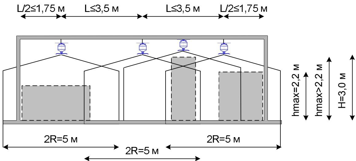
При расположении модулей пожаротушения «ТРВ Ураган-13» на высоте  $H=2,5$  и  $H=3,5$  м, высота орошения  $h_{max}$  на расстоянии  $L/2=1,75$  м от центра модуля, то есть половины стороны квадрата  $L=3,5$  м, составляет  $h_{max}=1,7$  м и  $h_{max}=2,7$  м соответственно.
