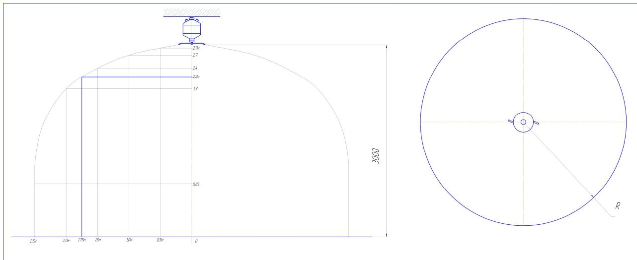
5.9. При расположении модулей пожаротушения «ТРВ Ураган-13» на высоте  $H=3,0$  м, на расстоянии друг от друга  $L\leq3,5$  м достигается наилучшее тушение пожара для оборудования, расположенного на высоте до  $h_{max}=2,2$  м.
