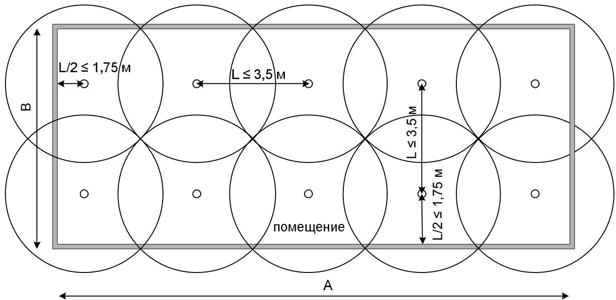
5.7. Для больших помещений с несколькими зонами пожаротушения при определении количества модулей «ТРВ Ураган-13» и расстояний между модулями, необходимо учитывать, чтобы расстояния между модулями смежных секций не превышали 3,5 м.
