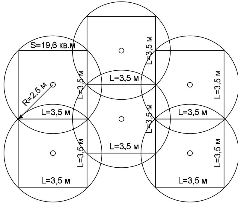
5.4. Минимальное количество модулей «ТРВ Ураган-13» в составе автоматической установки пожаротушения определяется по формуле:
