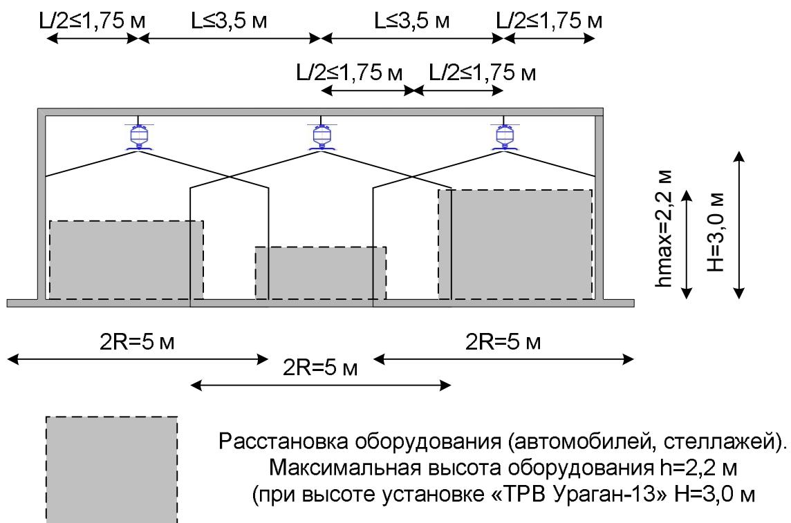
5.10. При расположении модулей пожаротушения «ТРВ Ураган-13» на высоте  $H=3,0$  м и расположении оборудования на высоте более  $h_{max}=2,2$  м, необходимо дополнительное размещение модулей пожаротушения «ТРВ Ураган-13», непосредственно над данным оборудованием.
