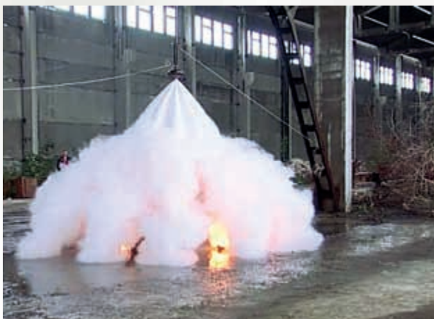
Распыл порошка при срабатывании МПП «Ураган-1М»
