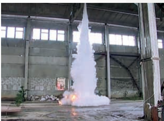
Распыл порошка при срабатывании МПП «Ураган-5М»
