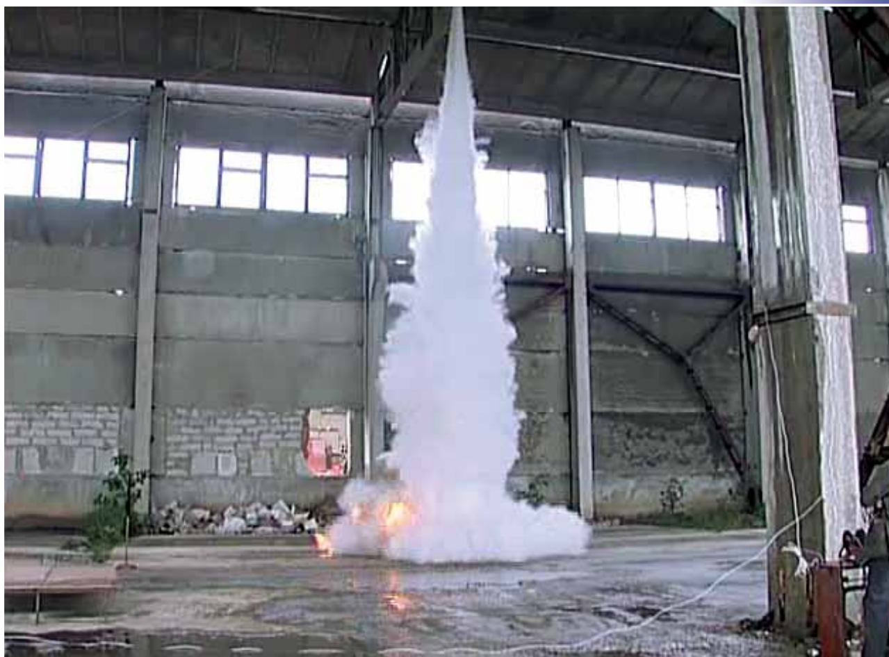
Распыл порошка при срабатывании МПП «Ураган-5М».
